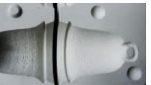
**eine aufgeklappte Gießform, Bild und Text spiegelbildlich eingraviert**
